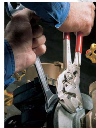
La pince-clé est employée comme outil d'assistance idéal, pour maintenir un boulon en place.
