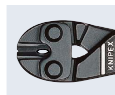
L'évidement à la base des tranchants facilite la coupe de fils plus épais, par ex. les tiges de plafonds suspendus
